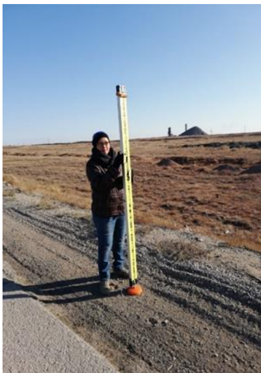
Рисунок 29 – Нивелирование на переходных точках
