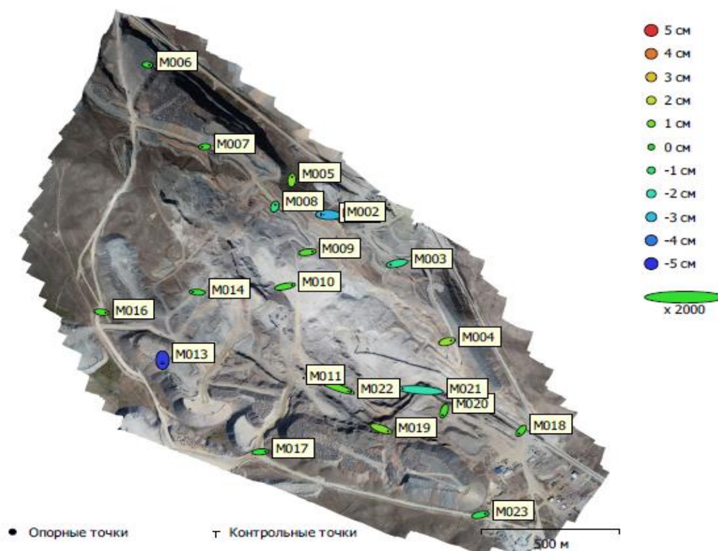
Рисунок 67 - Положение опорных и контрольных точек и оценка ошибок
