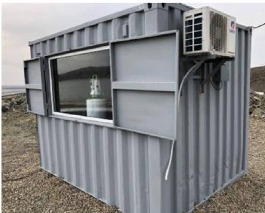
Рисунок 72 – Специальный контейнер с пилоном и тахеометром на хвостохранилище
